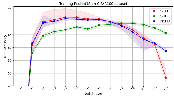
図 6 SGD, SHB, NSHB それぞれによって，CIFAR100 データセットで ResNet18 を 200 エポック訓練して得られるテスト精度とバッチサイズの関係．実線は 7 回の実行の平均値を表しており，7 回の実行の最大値と最小値の間を薄く塗りつぶしている．
